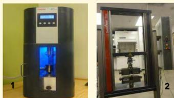
1. Préparation des éprouvettes par compression des granulés (Température de la matrice = 130°C, Température du moule = 35°C)
