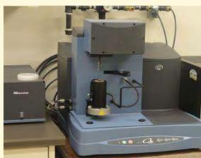
Test entre 25 et 800°C avec une vitesse de chauffage de 10°/min sous 60ml/min de flux d'azote.
