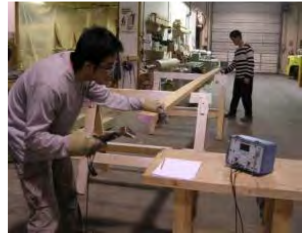
Mesure de la vitesse acoustique sur le bois de dimension
