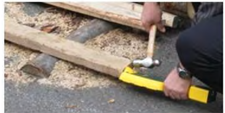
Mesure de la vitesse acoustique sur le bois de dimension
