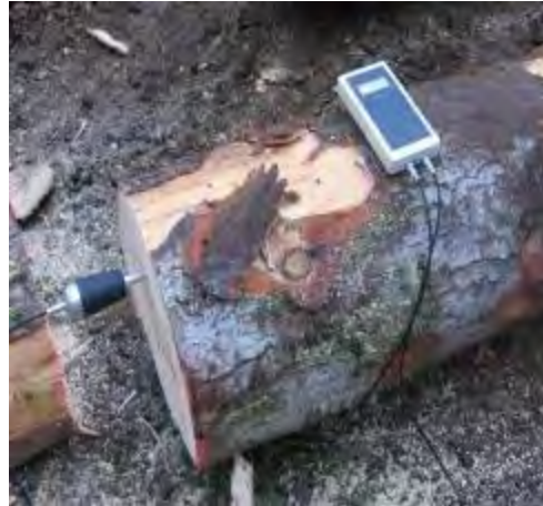
Mesure de la vitesse acoustique sur la bille
