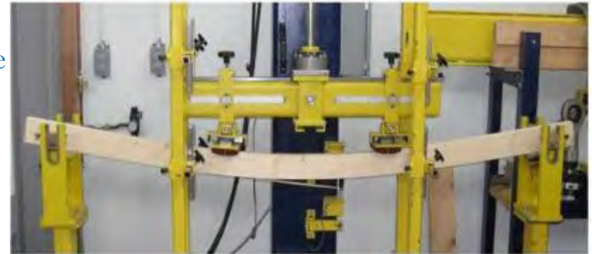
Banc d'essai pour les mesures de MOEstat et MOR (ASTM-D4761)
