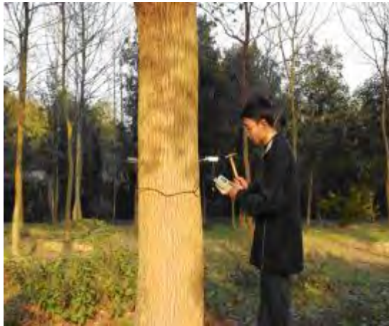
Mesure de la vitesse acoustique direct sur arbre debout
