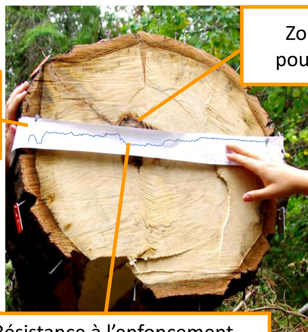
Résistance à l'enfoncement réduite au niveau de la zone de pourriture
