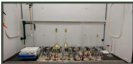
Fig 4: Quantification de l'indice hydroxyle par titration
