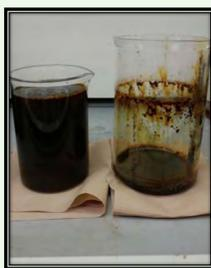
Fig 2: Récupération de la lignine pyrolytique par décantation (à droite)
