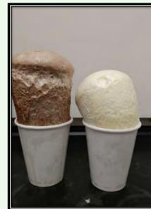
Fig 9: Polyuréthane biosourcé (à gauche) vs commerciale (à droite)
