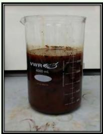
Fig 1: Ajout de l'eau à la biohuile de pyrolyse
