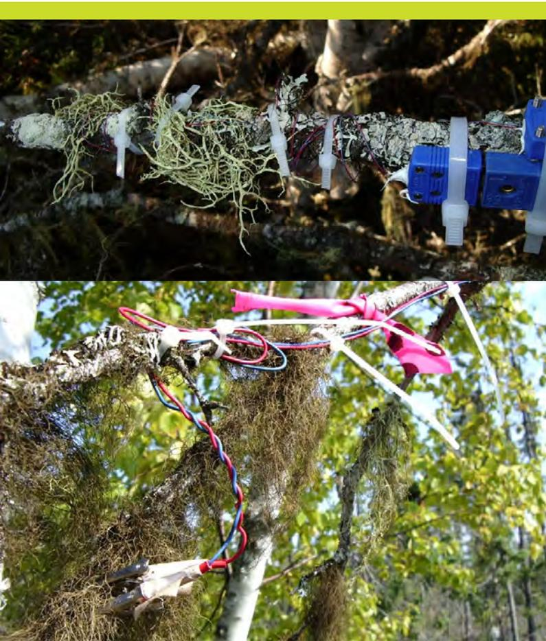
**Figure 4:** Sondes mesurant l'humidité, la température et le rayonnement photosynthétique.
