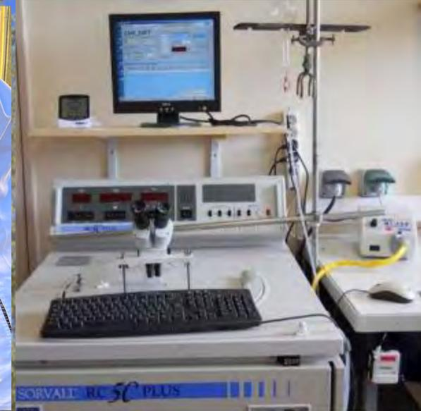
Cavitron: mesurer la vulnérabilité à la cavitation d'un échantillon de tige
