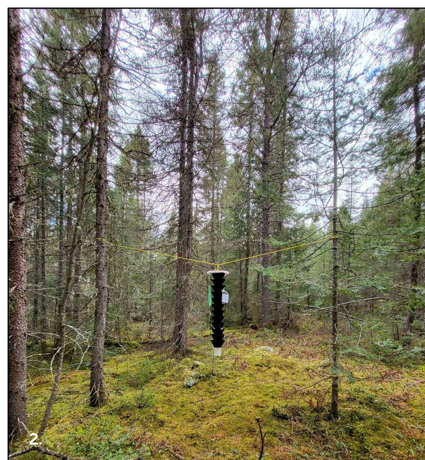
La figure 1. Montre le vaste réseau de sites de piégeage entre Mt. Laurier et La-sarre; La figure 2. montre un entonnoir Lindgren installé entre deux conifères sur un site.
