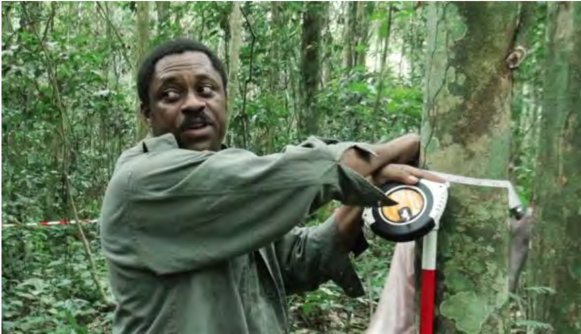
Les Diamètres sont mesurés à 1,30m du sol et à 30cm après le contrefort le plus haut
