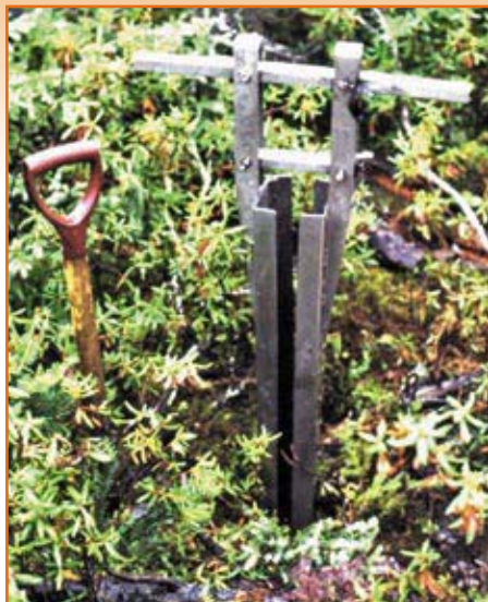
FIGURE 3 : Sonde Wardenaar, utilisée pour récolter des profils tourbeux.
