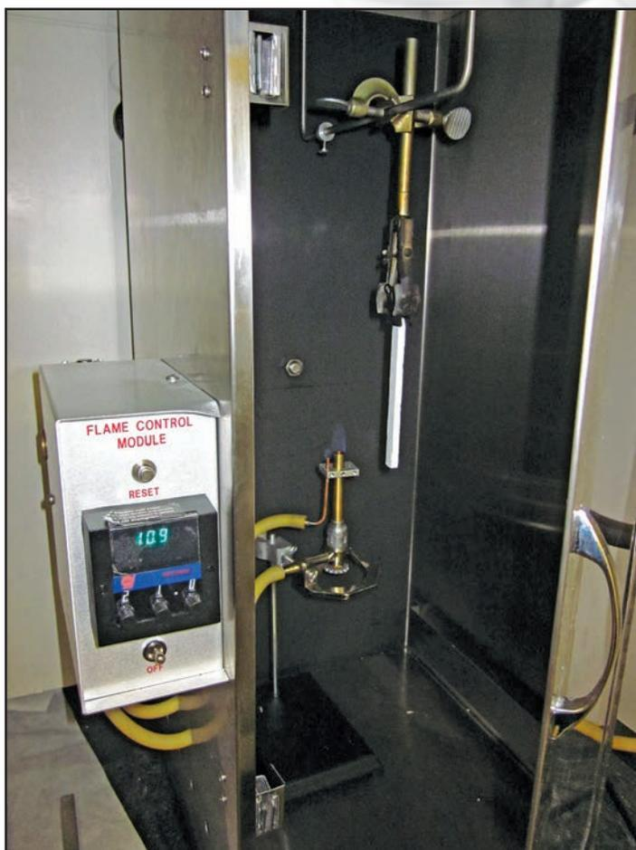
**Appareil pour tester la propagation verticale du feu**
