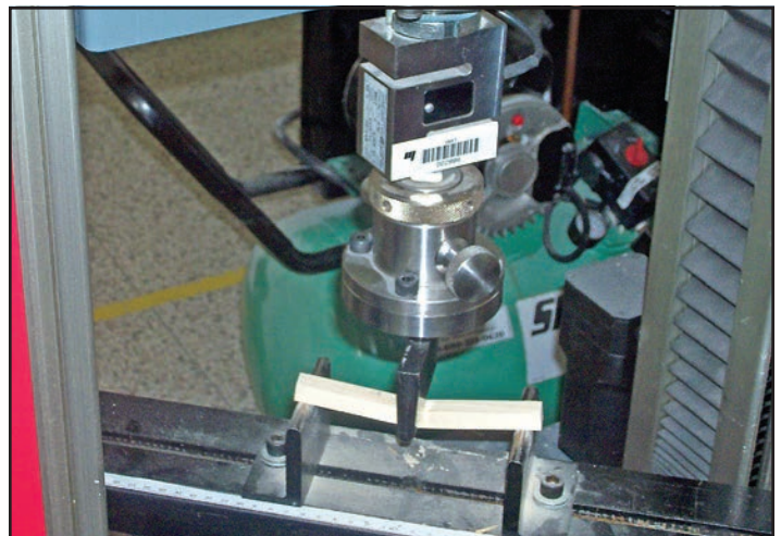
Test de résistance en flexion
