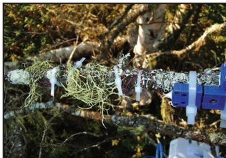
**Capteurs pour mesurer la température**
