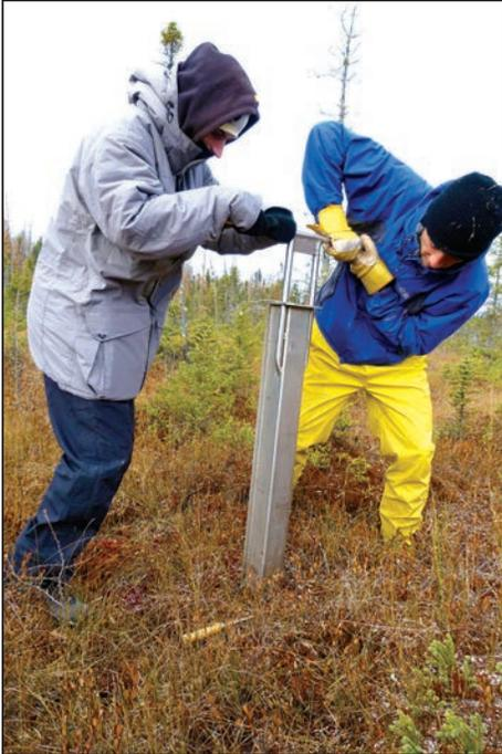
*Le prélèvement des échantillons de tourbe (carottes) s'effectue à l'aide d'un carottier. Le carottier est enfoui dans le sol et retiré par la suite en entraînant avec lui une portion de l'épais manteau de tourbe*
