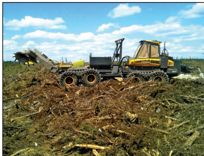
Le scarificateur est la machine de travail du sol la plus utilisée en forêt boréale
