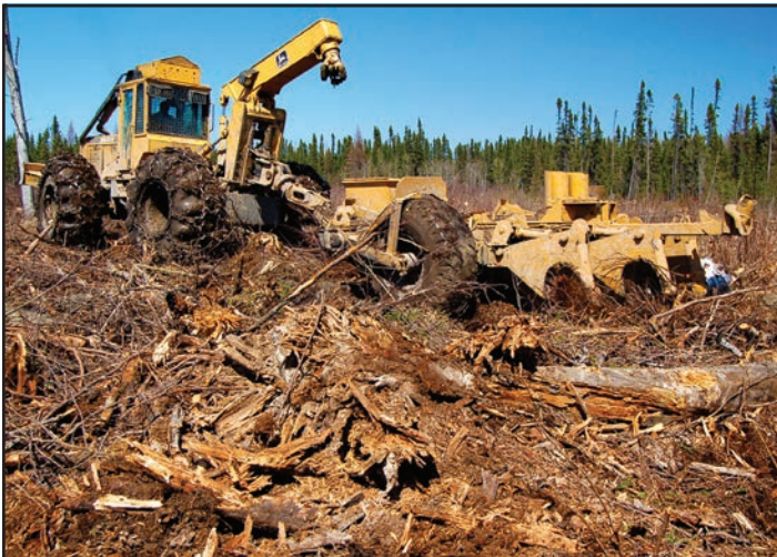
En Abitibi, la herse forestière est utilisée pour travailler les sols argileux et les terrains en friche
