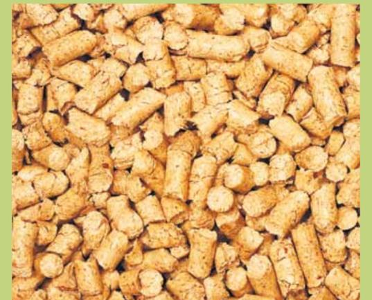
Granules de bois constitués de biomasse forestière pour utilisation dans un appareil de chauffage. - Photo: Shutterstock
