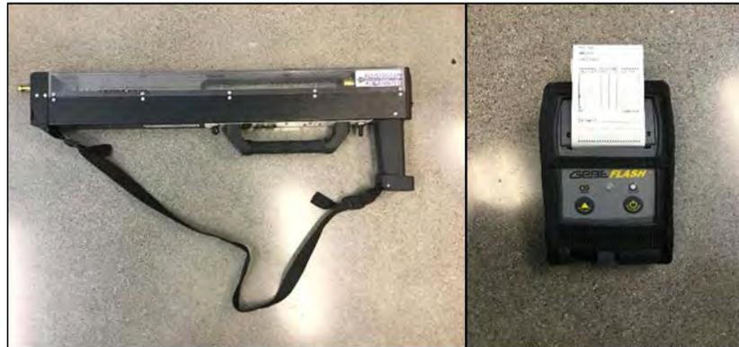
**Figure 2.1** Le résistographe et ses équipements
