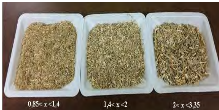
Figure 2.3 Trois différentes granulométries des échantillons des bois utilisés pour les tests de pyrolyse (G1 : 0,85 < x < 1,4 mm ; G2 : 1,4 < x < 2 mm et G3 : 2 < x < 3,35 mm)
