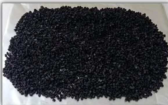
Figure 3.7 Échantillon de biochar encapsulé dans le polyéthylène haute densité
