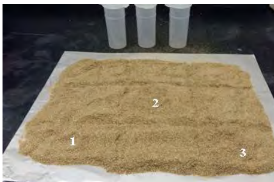
Figure 2.4 Principe d'échantillonnage du bois traité à l'ACC : 1, 2 et 3 les compartiments à mélanger
