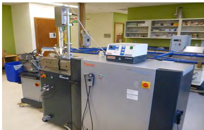
Figure 2.6 Extrudeuse bis-vis disponible au laboratoire de biomatériaux de l'UQAT et utilisée pour les essais d'encapsulation du biochar
