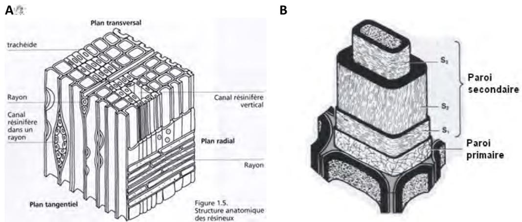
Figure 2.6 A. Représentation tridimensionnelle d'un plan ligneux. B. Structure d'une trachéide d'un résineux (Plomion *et al.*, 2001).
