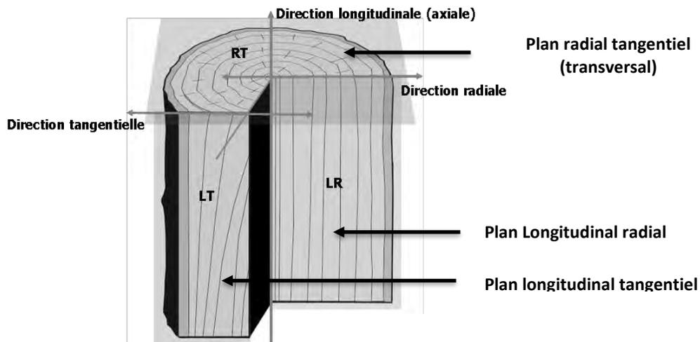
Figure 2.3 Axes et plans naturels d'observations (adapté de Kollmann et Côté, 1968).
